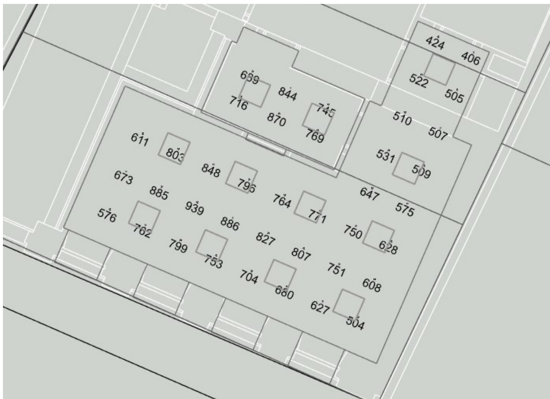
Obr. B.1 – 1.12. a 1.13 Normálová udržovaná osvětlenost pro osvětlení úkolu a bezprostředního okolí úkolu (výška srovnávací roviny 0,45 m nad podlahou v 1.12 a 0,85 m nad podlahou v 1.13)
