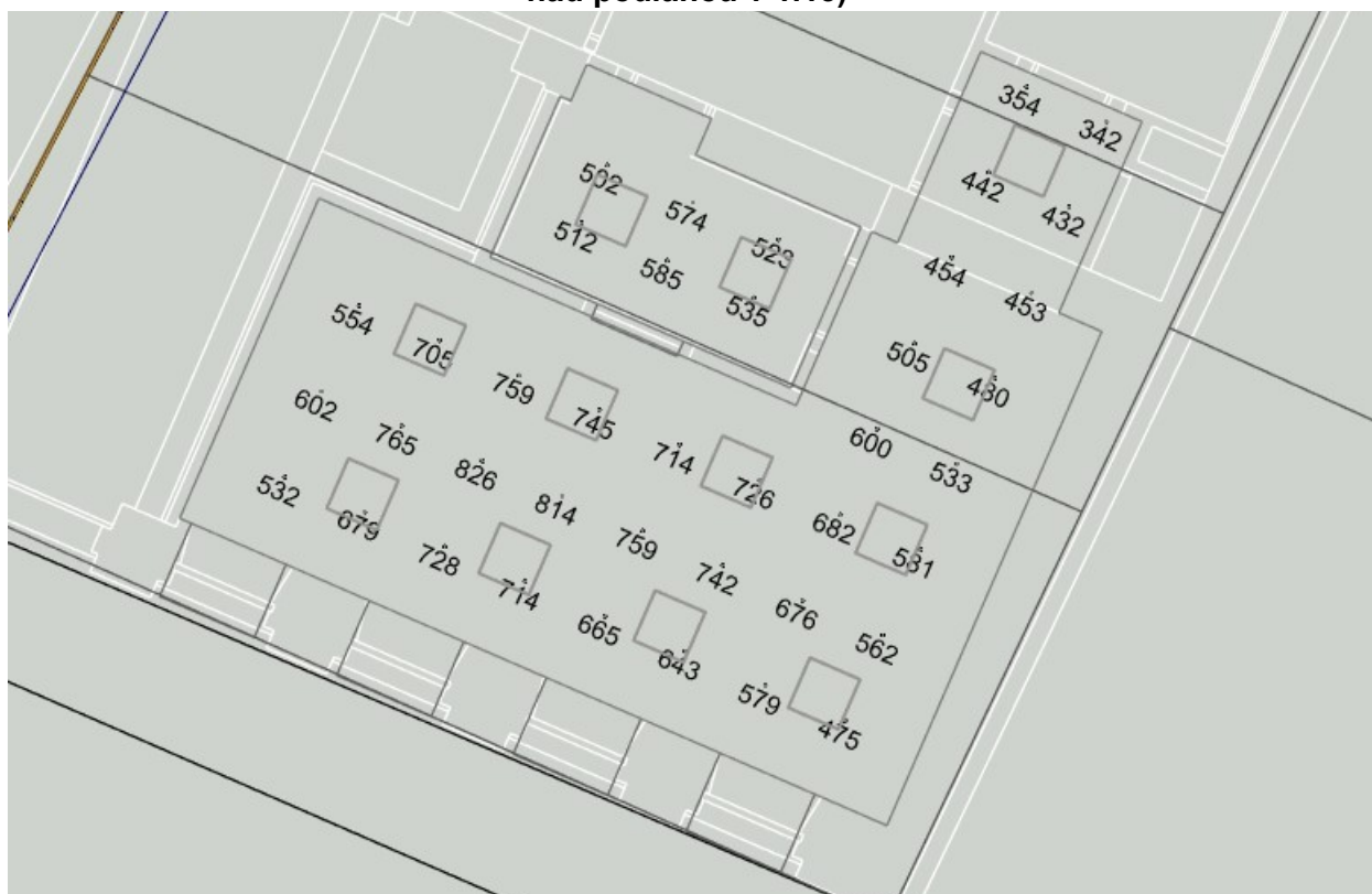
Obr. B.2 – 1.12. a 1.13 Normálová osvětlenost pro pozadí úkolu (výška srovnávací roviny 0,00 m nad podlahou)
