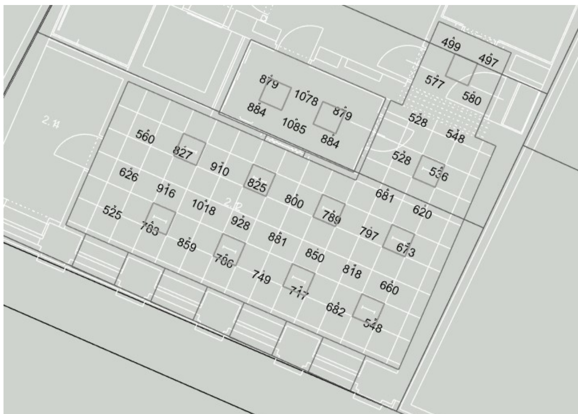
Obr. B.4 – 2.12. a 2.13 Normálová udržovaná osvětlenost pro osvětlení úkolu a bezprostředního okolí úkolu (výška srovnávací roviny 0,45 m nad podlahou v 2.12 a 0,85 m nad podlahou v 2.13)
