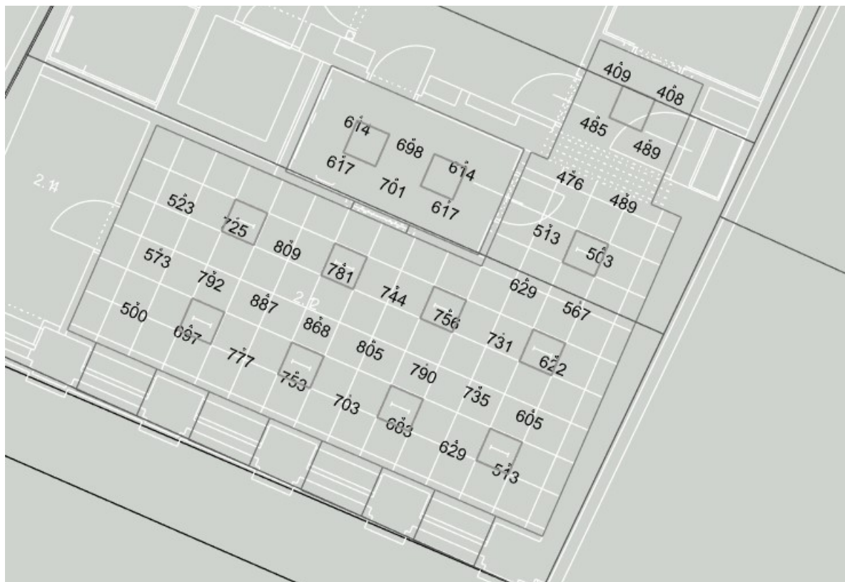
Obr. B.5 – 2.12. a 2.13 Normálová osvětlenost pro pozadí úkolu (výška srovnávací roviny 0,00 m nad podlahou)
