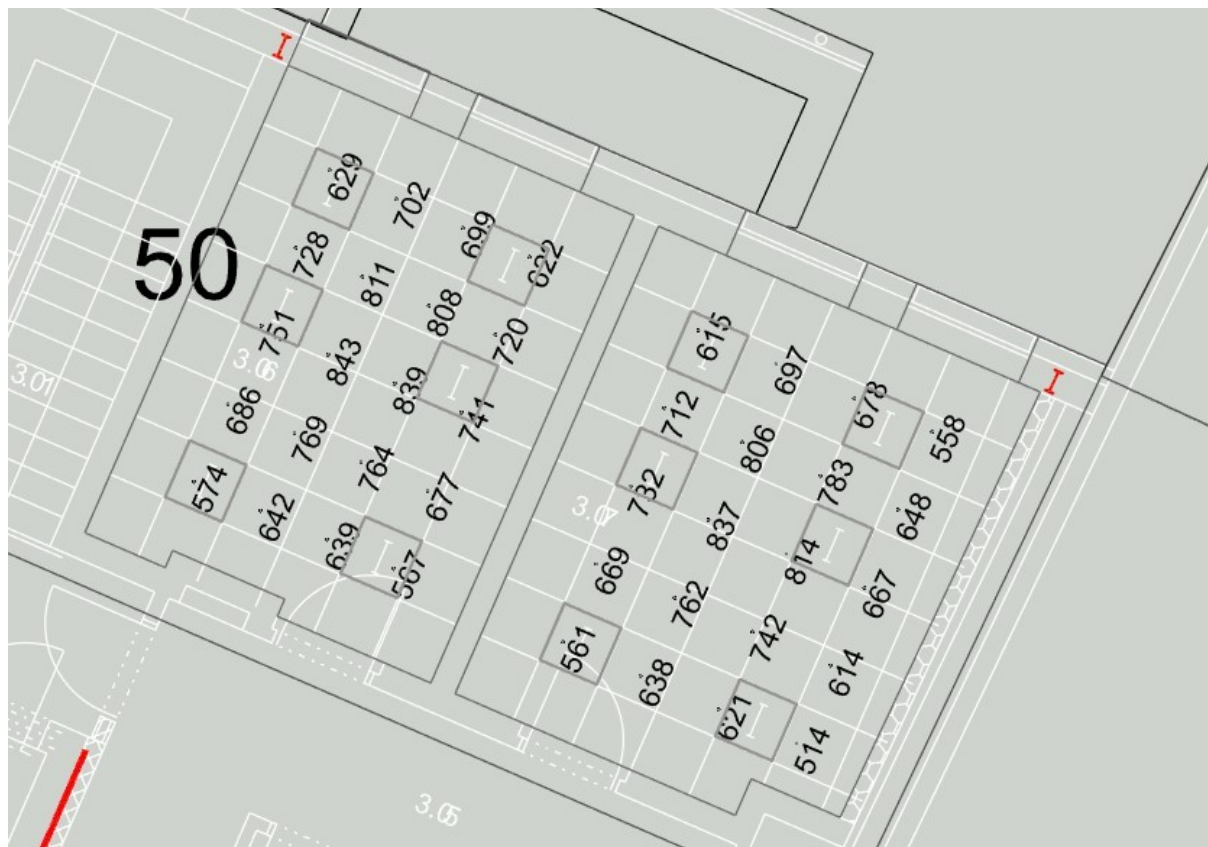
Obr. B.8 – 3.06 a 3.07 Normálová osvětlenost pro pozadí úkolu (výška srovnávací roviny 0,00 m nad podlahou)
