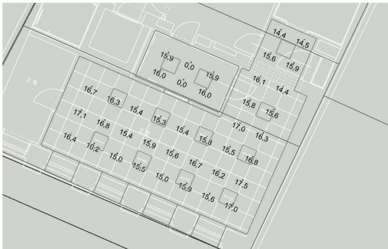
Obr. B.6 – 2.12. a 2.13 Činitel oslnění R_{UGL} (výška srovnávací roviny 1,0 m nad podlahou v 1.12 a 1,6 m v 1.13)
