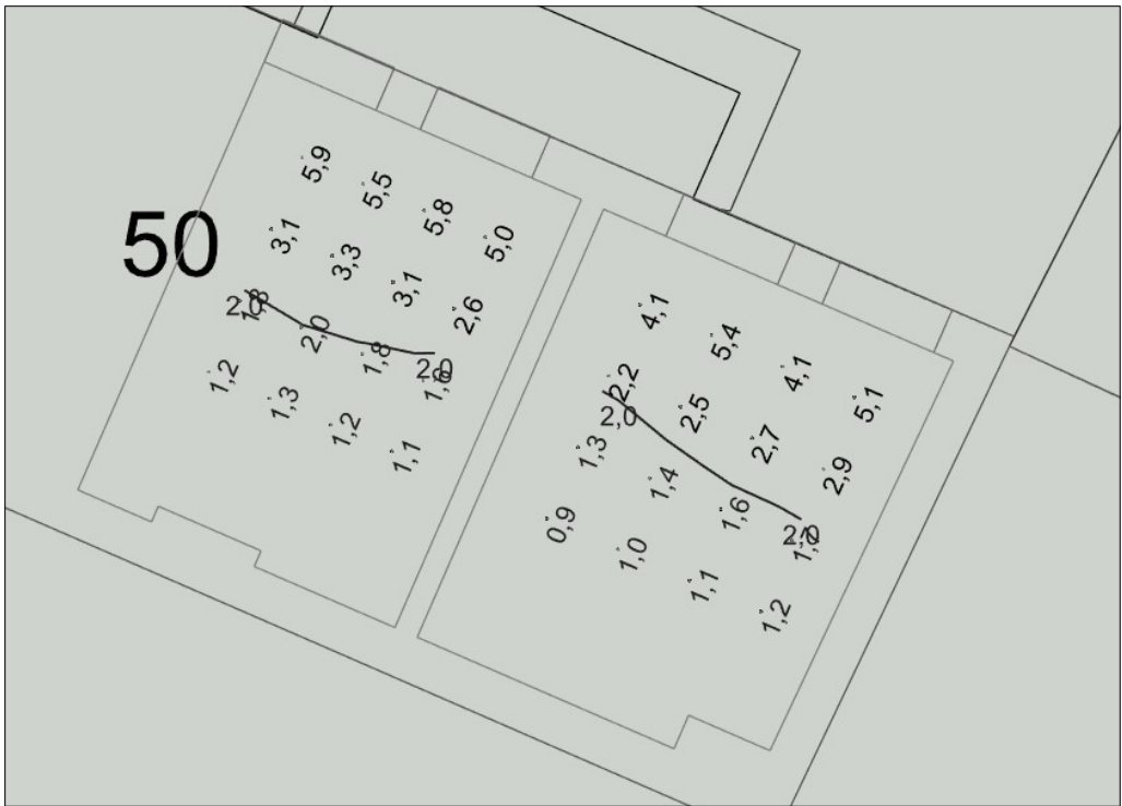
Obr. 10 – Učebny 3.06 a 3.07 – činitele denní osvětlenosti - vymezená plocha
