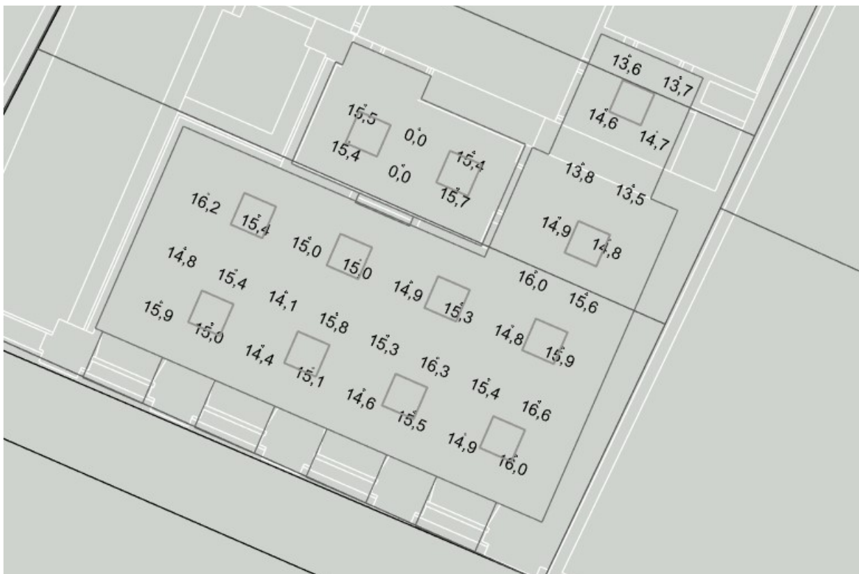
Obr. B.3 – 1.12. a 1.13 Činitel oslnění R_{UGL} (výška srovnávací roviny 1,0 m nad podlahou v 1.12 a 1,6 m v 1.13)
