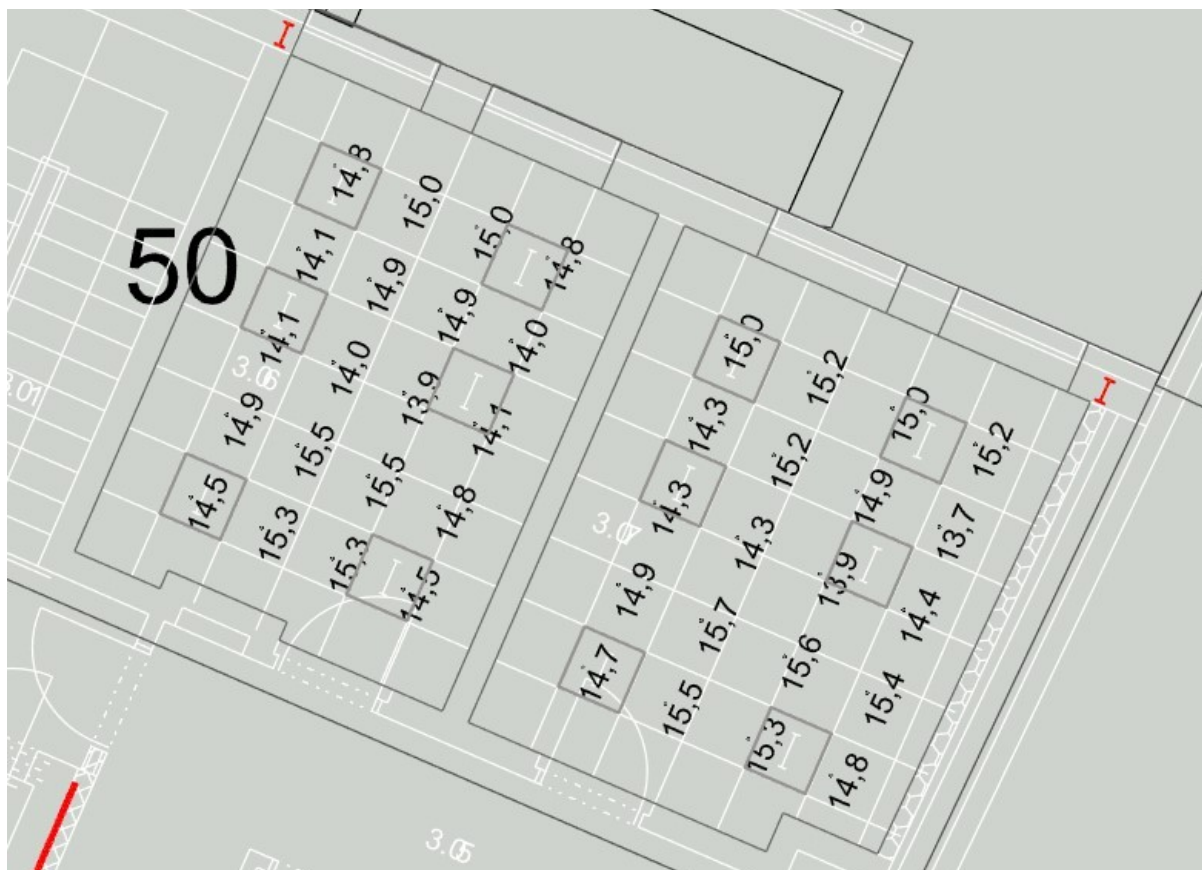
Obr. B.9 – 3.06 a 3.07 Činitel oslnění R_{UGL} (výška srovnávací roviny 1,2 m nad podlahou)
